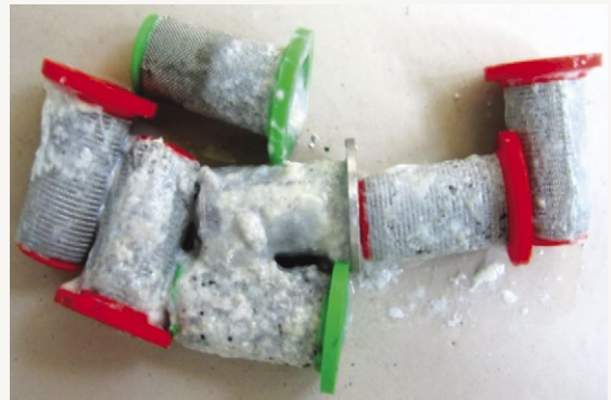
Foto 1. Biofilm su filtri in un impianto di lubrificazione con lubrificante amminico.
