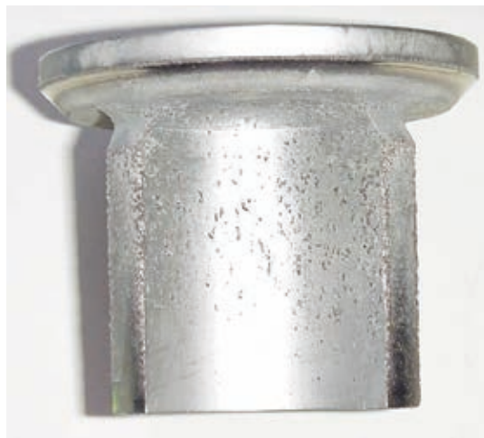
Figura 2 – Buchi da corrosione su acciaio e buchi da corrosione su stampo per cioccolato in policarbonato (microscopio)
