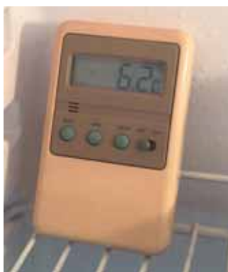
Fig. 3 – La temperatura reale all'interno di un comune frigorifero domestico può essere anche superiore al limite dei 4 °C ed è importante avere un sistema di misura del suo reale valore.
