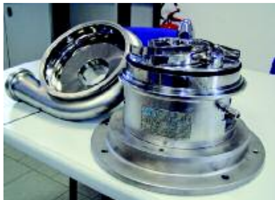
Figura 3 – Pompa centrifuga progettata secondo i criteri di igiene e certificata Ehedg.
